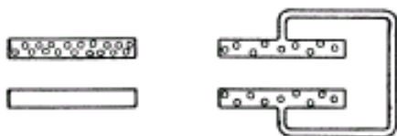
3. ábra. Kondenzátor megtöltött és kisütött állapotban.
