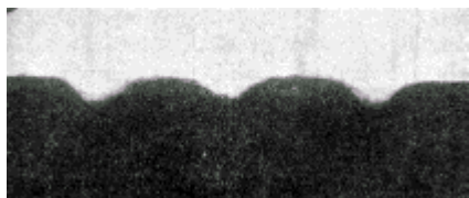
6. ábra. Gramofonlemez keresztmetszetének mikrofotográfiája 100-szoros nagyításban. (Szerző felvétele.)
