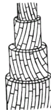
6. ábra. A kristályelemek elhelyezkedése a cellulóze-rostban.
